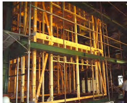
日本建築学会特別研究委員会「木構造と木造文化の再構築」による実大振動実験（京都大学防災研究所）
